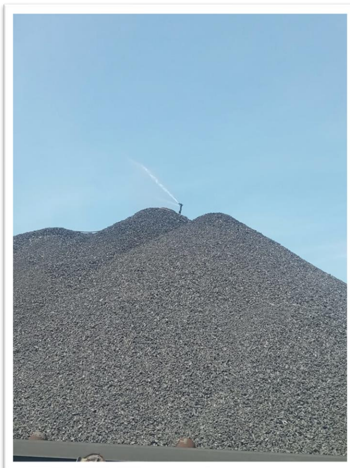
Imagen No 11, 12 y 13. Humectación Patio Carbón
