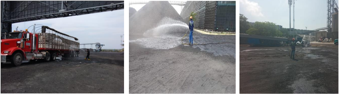
Imagen 4, 5 y 6. Registro Fotográfico de lavado de vehículo, riego en el interior de la operación y riego de vías internas de la instalación portuaria.
