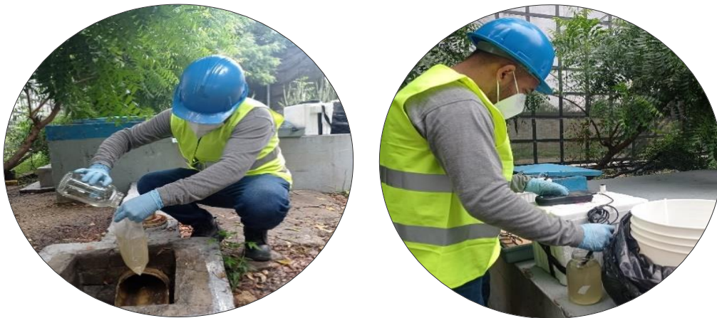
Imagen 1. Técnico de Laboratorio tomando muestra de ARD y analizando los parámetros In situ
